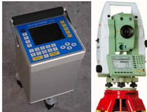
Figure 3 : Microgravimétrie | Matériel de mesure utilisé Microgravimètre CG5 (à gauche) et tachéomètre robotisé LEICA TS12 (à droite)
