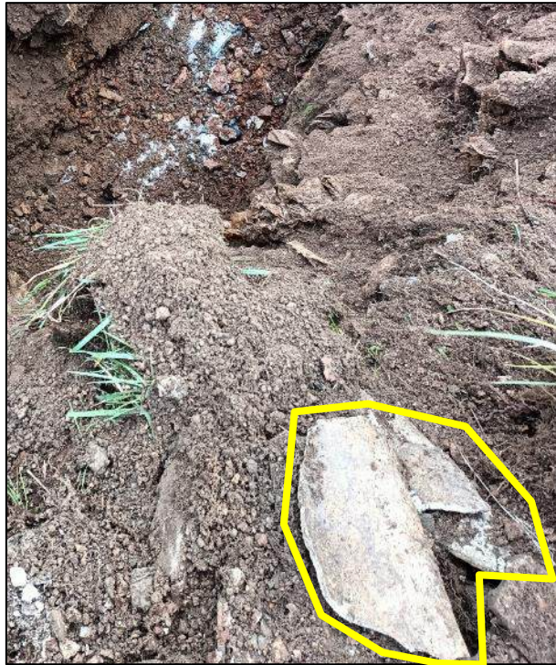
Figure 15 Plaque d'amiante trouvée en S3
