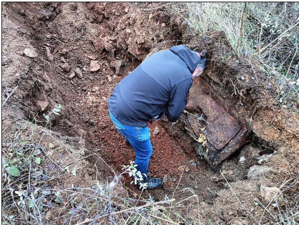
Figure 19 Réalisation d'un essai au scissomètre dans la pelle S1
